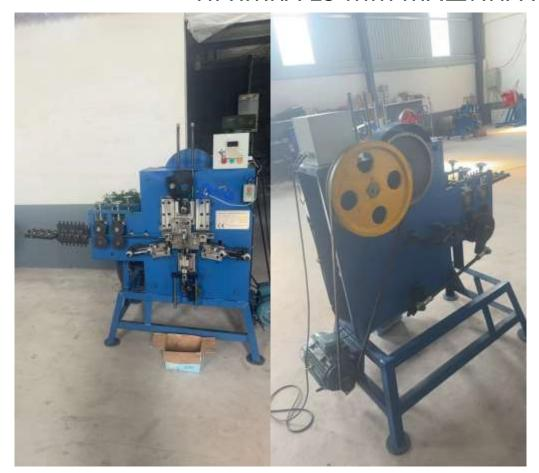
Применение машины: используется для изготовления проволочной пряжки 19 мм для лент из композитного волокна.
